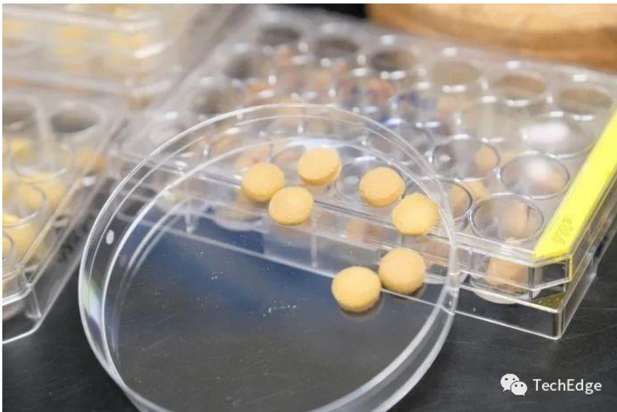
在涉及各种类型的油类和溶剂的实验室测试中，研究人员发现海绵的吸收能力与市面上的聚丙烯吸收剂相似。不过，与那些以石油为基础的产品不同的是，花粉海绵是由可再生材料制成的，一旦被丢弃就会生物降解--此外，每块海绵在需要更换之前，至少可以拧干重复使用 10 次。
